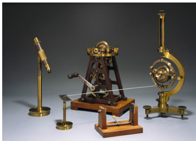
Figure 6. Matériel pour l'expérience du gyroscope de Foucault, construit par Dumoulin-Froment vers 1883. Voir aussi le Recueil des travaux scientifiques de Léon Foucault... (1878) pour des planches explicatives des différents instruments et du montage
